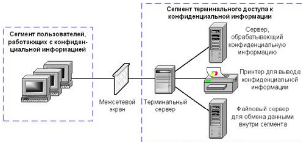
Рисунок 1 – Схема установки терминального сервера доступа к конфиденциальным данным
