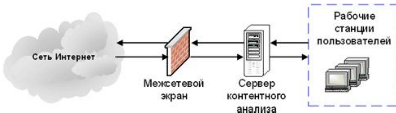
Рисунок 2 – Схема установки средств контентного анализа в АС
