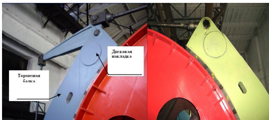
Рисунок 6 – Практическое применение дисковых накладок при ремонте тормозной балки шахтной подъемной машины НКМЗ
