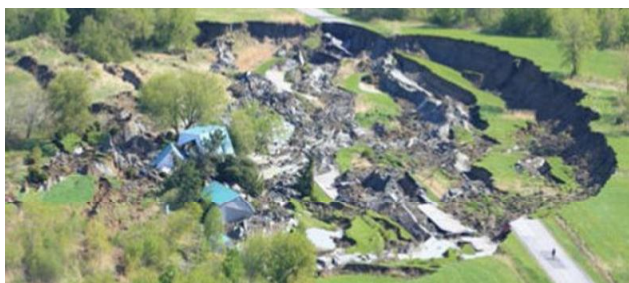
Рисунок 2 – Оседание земной поверхности над горными выработками
