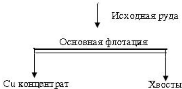
Рисунок 2 – Схема флотации медной руды в открытом цикле
