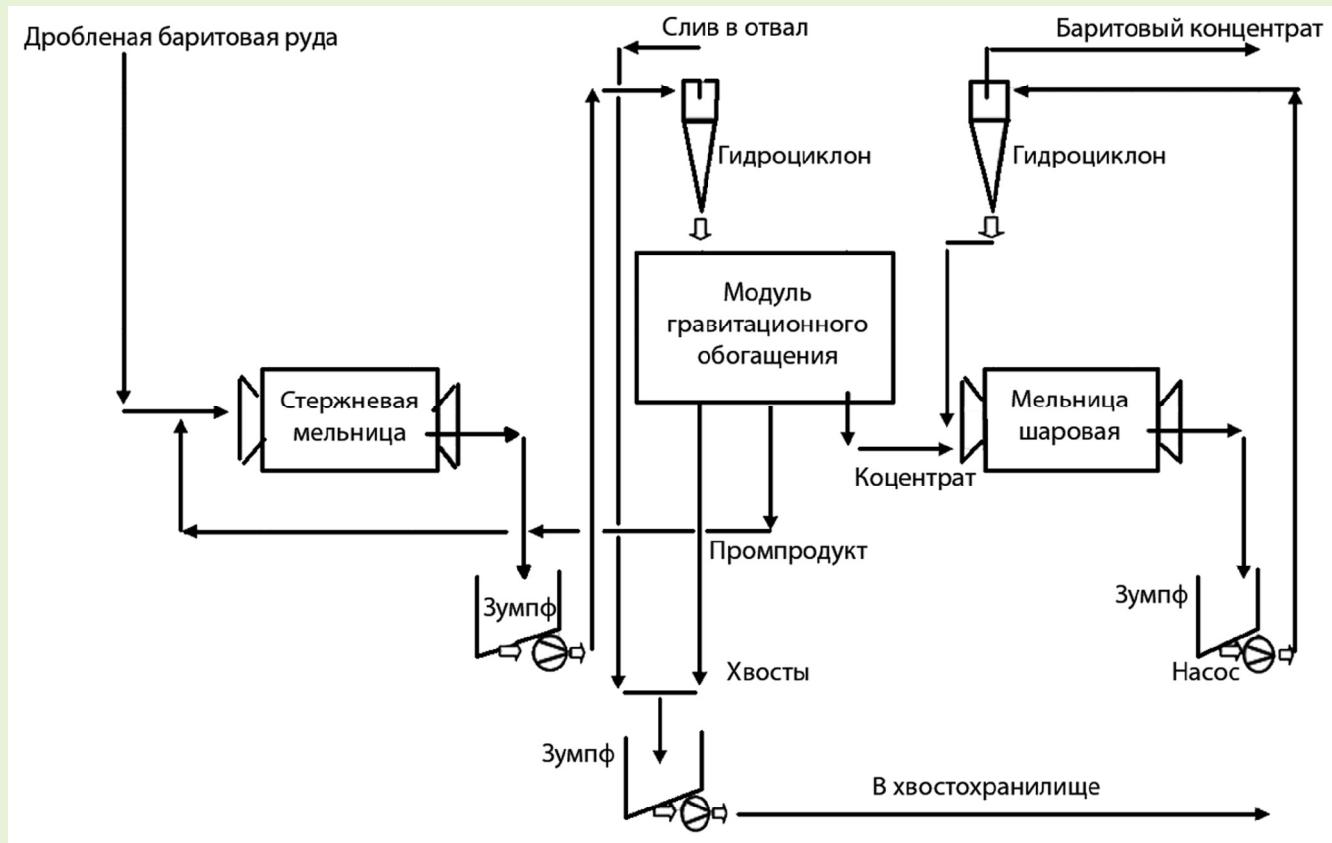
Рис. 2. Альтернативная схема гравитационного обогащения баритовой руды.
