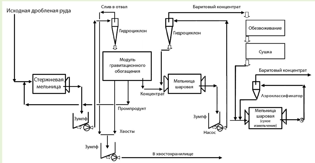
Рис. 1. Основная схема гравитационного обогащения баритовой руды.
