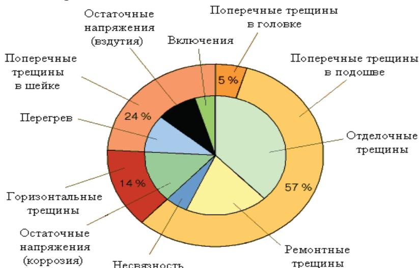
Рисунок 4 - Виды и причины дефектов в швах, выполненных газопрессовой сваркой
