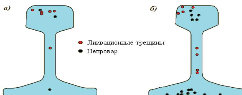
Рисунок 2 - Местоположение неоднородностей металла в рельсе, инициирующих зарождение дефектов:
